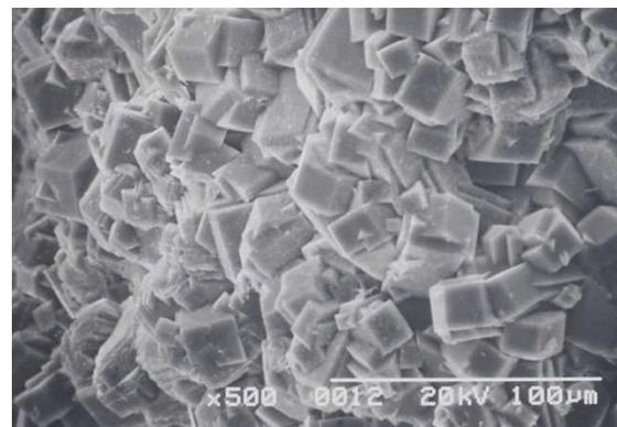
**Gambar 5.** Foto SEM permukaan membran zeolit MFI
